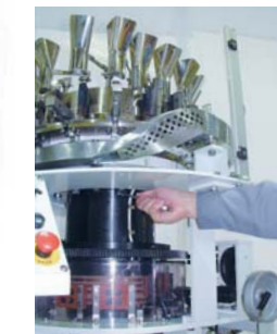
① 中継電気配線、及びユニット固定ボルトを取りはずします。
