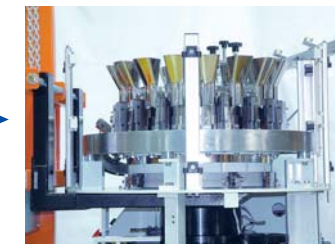
② ハンドリフトをロータリー中間パネル下側に差し込みます。
